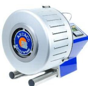
Schnellbewitterungsgerät in kompakter Bauweise zur Beschleunigung der natürlichen Bewitterung. Die Proben werden einem Soll-Niveau der UV-Strahlung ausgesetzt, das ungefähr „2 Sonnen“ entspricht. Dies erlaubt eine erhebliche Beschleunigung der Bewitterung und ist ähnlich der natürlichen Bewitterung.
