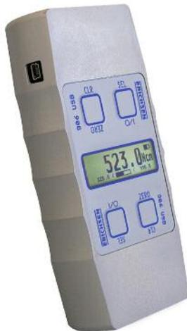
Zur Erfassung von mechanischen Größen auf der Basis von Dehnungsmessstreifen-Sensoren; lieferbar mit integriertem Kraftaufnehmer (Messbereiche von 20 N bis 1000 N möglich) oder als reines Anzeigergerät zum Anschluss von externen Sensoren; mit USB-Schnittstelle und kostenloser zugehöriger Mess- und Auswertesoftware (Download); Anzeige auf dem Display kann um 180° invertiert dargestellt werden. Geeignet für den mobilen (Batteriebetrieb) und den stationären Einsatz (Netzteilbetrieb).
